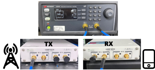
그림 5. 실험을 위한 USRP 안테나 연결 Fig. 5. USRP antenna connection port for PRS
